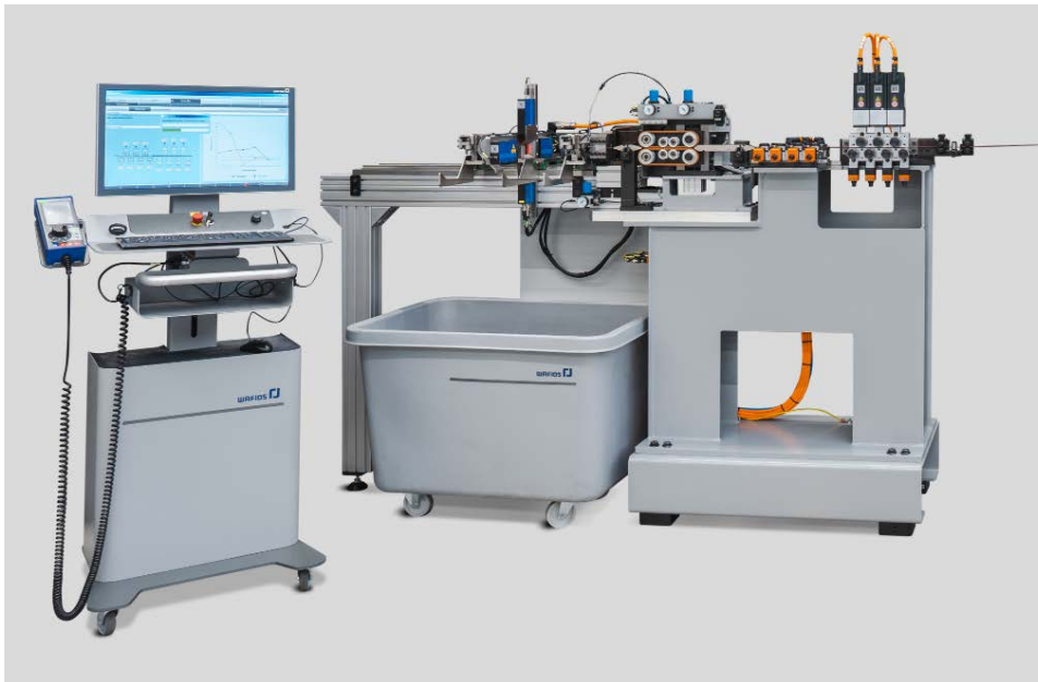
Versuchsaufbau „iQsmartstraight“ für Flachmaterial Kupfer. © Wafios
