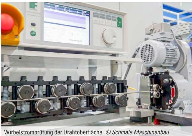
Wirbelstromprüfung der Drahtoberfläche. © Schmale Maschinenbau
