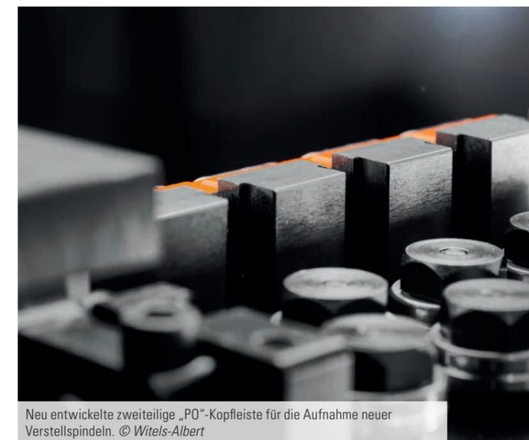
Neu entwickelte zweiteilige „PO“-Kopfleiste für die Aufnahme neuer Verstellspindeln. © Witel-Albert
